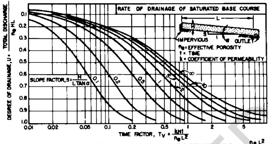
SELECT DRAIN SPACING, L SO THAT 50% DRAINAGE WILL BE COMPLETED IN 10 DAYS.
