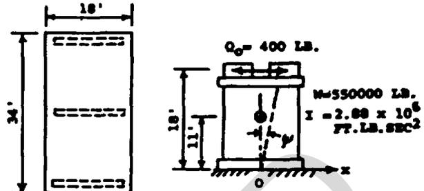
DESIGN CRITERION : 0.20 IN / SEC HORIZONTAL MOTION AT MACHINE CENTERLINE
