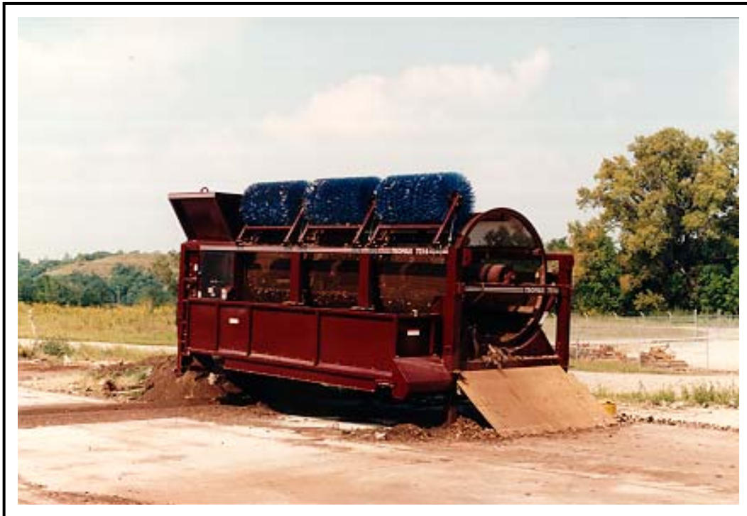
Figure A-22. Trommel screen.
