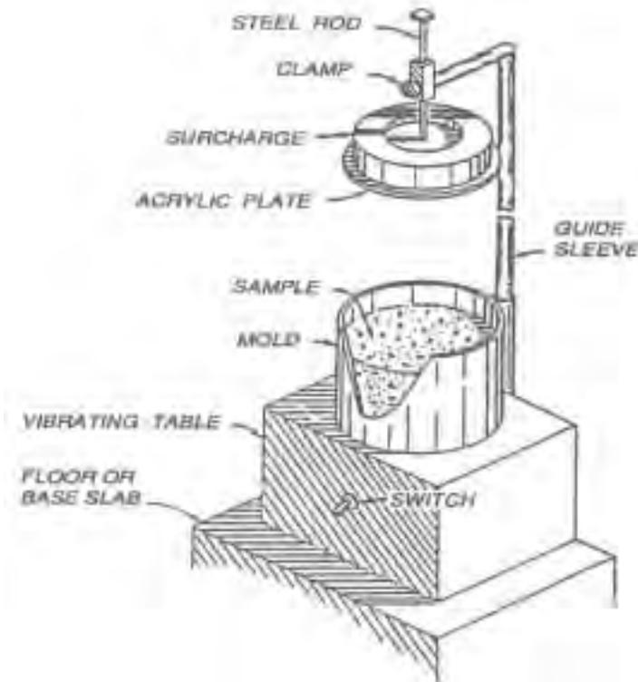
Fig. 1. Modified Vebe test apparatus
